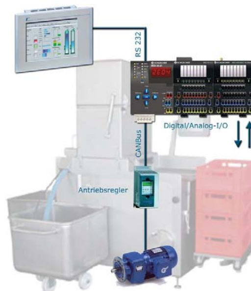
Bild 2: Steuerungsaufbau des Rühle-Pökelzentrums
